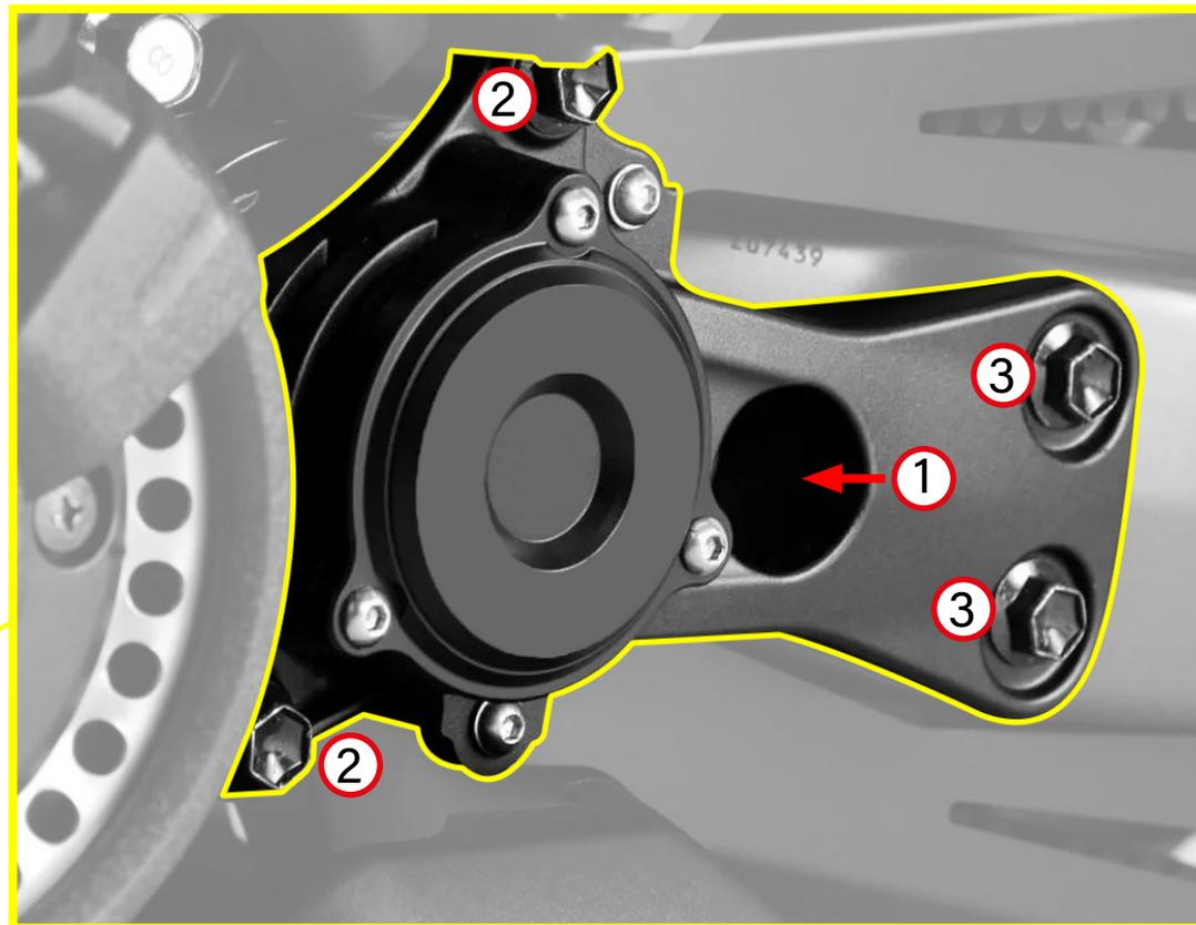
Rimuovere il pignone originale dal supporto utilizzando l'apposito estrattore. Prima di rimontarlo, eseguire tutti i controlli previsti dal manuale Yamaha sulla cinghia di trasmissione: se è usurata o deteriorata è necessario sostituirla.
